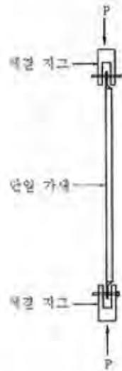
[그림 11] 단일 가새의 압축 하중 시험
