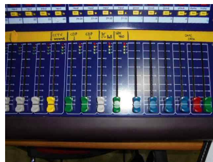
그림 76 콘솔 표면에 사용정보 표기 예
