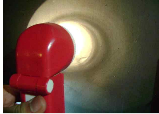
그림 43 휴대용 비상조명등 점등 및 밝기 확인
