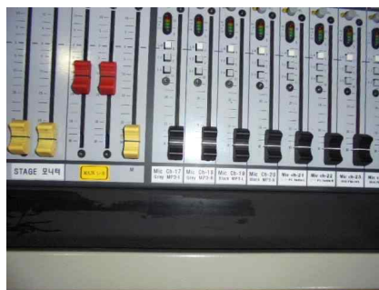
그림 75 콘솔 표면에 사용정보 표기 예
